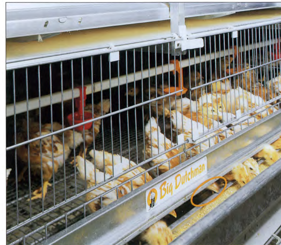
育雛ケージ: 幼雛用給餌窓及び餌こぼしを防ぐインナーリム
