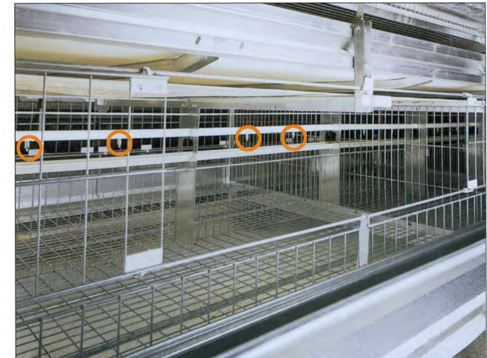
育雛ケージUV-S 630: 4個のステンレスカップが雛に十分な飲水を供給します。
